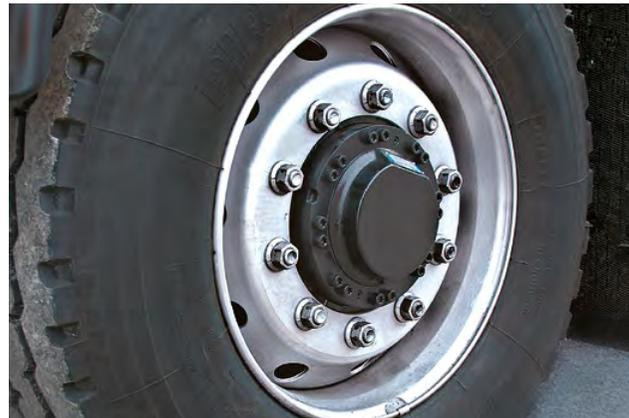
Vorderachse mit hydrostatischen Radnabenmotoren
