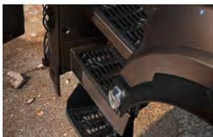
**Die bei Geländefahrten beschädigungsanfällige untere Trittstufe ist jetzt mit einer Pendelfunktion ausgestattet. Die Befestigungslaschen sind aus elastischem Kunststoff – so können sie sich bei Bodenkontakt verformen und anschliessend in ihre Ursprungsform zurückkehren.**
